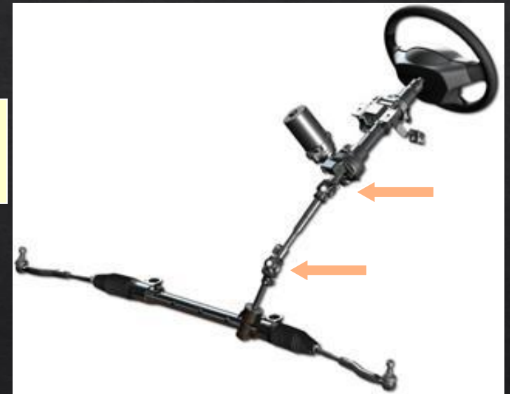
Układ kierowniczy samochodu osobowego z przekładnią zębatkową i wspomaganiem
