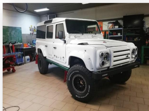
Rys.19 Polski samochód elektryczny Sokół 4x4: baza z Land Rovera, bateria 85 kWh, moc 272 KM 26
