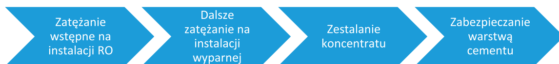
Rys. 2. Schemat przetwarzania ciekłych odpadów promieniotwórczych nisko- oraz średnioaktywnych krótkożyciowych (opracowanie własne) Figure 2. Diagram of the processing of short-lived low-activity and medium-active liquid radioactive waste
