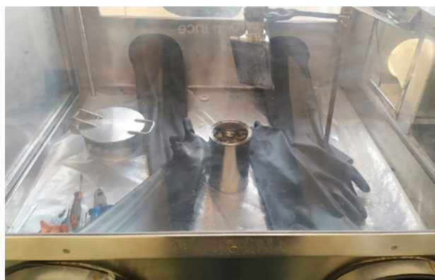
Fot. 10. Wnętrze komory rękawicowej do demontażu izotopowych czujek dymu. Na środku widoczna jest stalowa puszką ze zdemontowanymi źródłami
