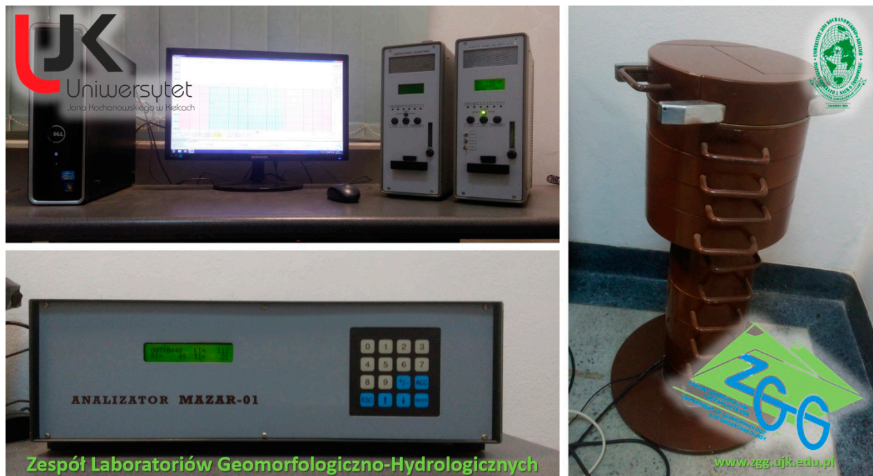
Fot. 3. Wyposażenie Zespołu Laboratoriów Geomorfologiczno-Hydrologicznych w Instytucie Geografii i Nauk o Środowisku Uniwersytetu Jana Kochanowskiego w Kielcach. Czytelniki TL oraz OSL „Laboratory Reader-Analyser RA'04” (górze), mierniki stężenia pierwiastków promieniotwórczych „MAZAR-01” (dół) oraz kolumna pomiarowa (z prawej; fot. P. Przepióra)
