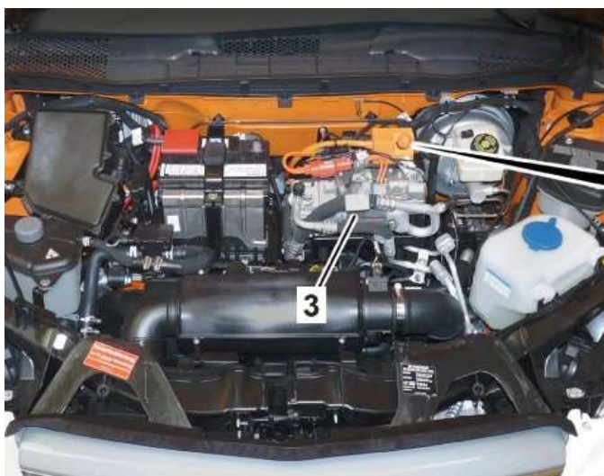
Pociągnąć pierścień zabezpieczający (1) w górę / odłączyć wtyk (2)
