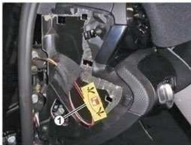
Przeciąć przewód w oznaczonym miejscu (1)
