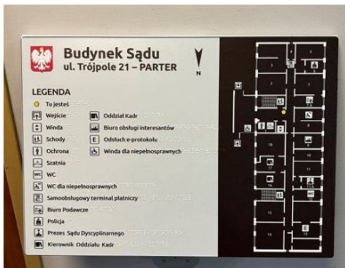
Zdjęcie 20 : Plan tyflograficzny z informacji w alfabecie Braille'a w Sądzie Apelacyjnym w Poznaniu
