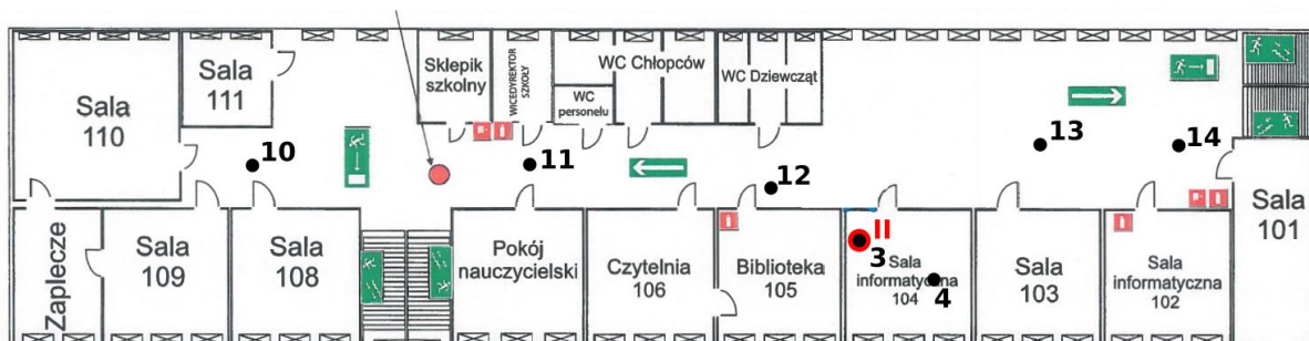
Rys. 1a: Plan rozmieszczenia punktów pomiarowych – parter, kolorem czerwonym oznaczono lokalizację punktów dostępnych
