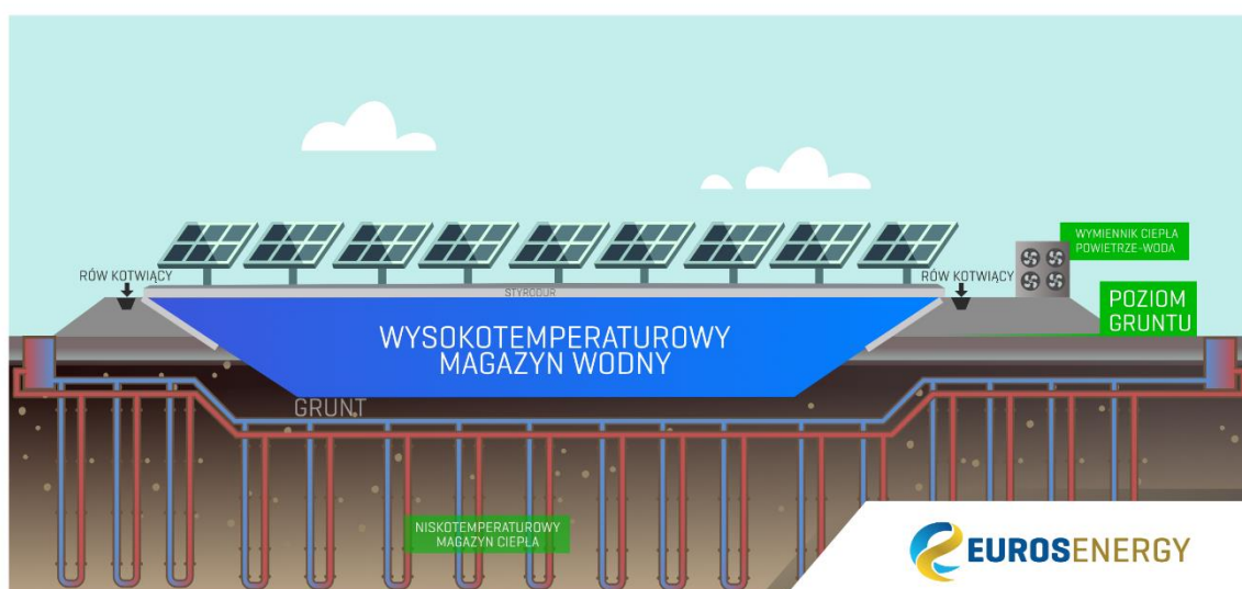
Rysunek 6. Warstwowe ułożenie komponentów Demonstratora Technologii pozwala na zmniejszenie zajętości terenu
