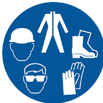
Rys. 9. Przykładowe znaki nakazujące stosowanie środków ochrony indywidualnej.
