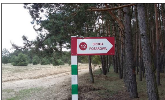
Ryc.36. Oznaczenie dojazdu pożarowego
