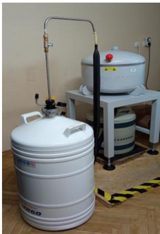
Spektrometr promieniowania gamma z detektorem półprzewodnikowym HPGe
