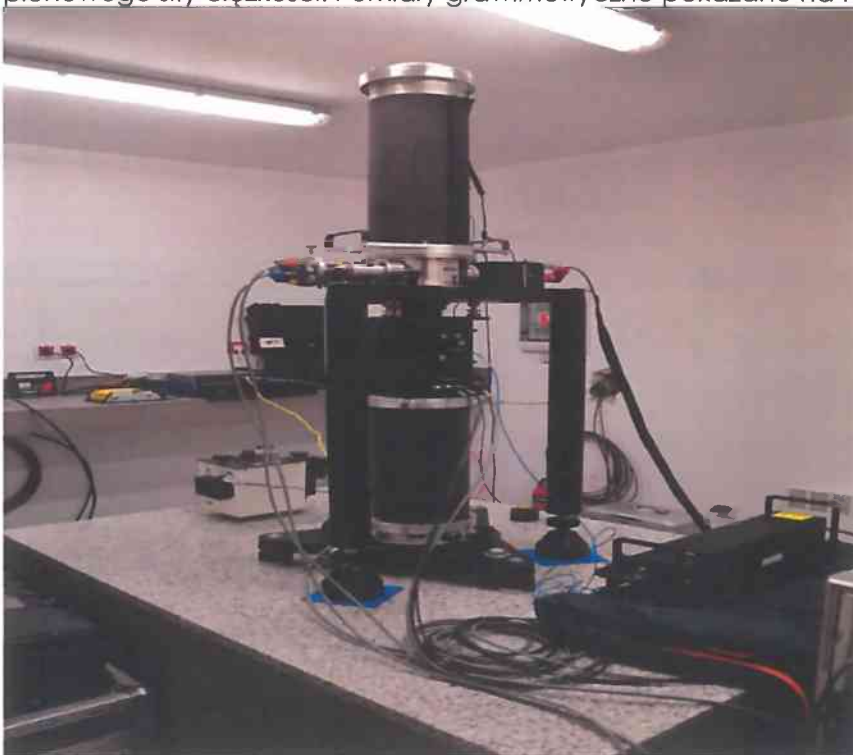
fol. 3. Grawimetr FG-5 w trakcie absolutnych pomiarów przyspieszenia siły ciężkości w Dziwiu w dniach 7-9 listopada 2018 r.
