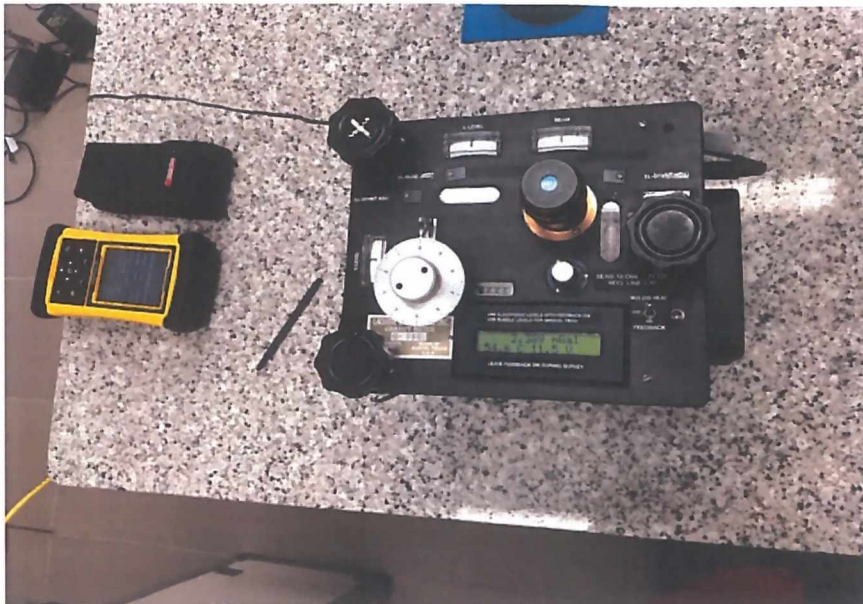
Fot. 4. Grawimetrz pływowy w trakcie wykonywania pomiarów w Hołowni w dniu 14-16 listopada 2018 r.
