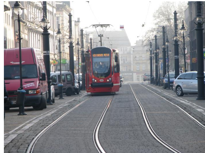
Fot. 4. Świętochłowice, RB1. Zmodernizowany wagon Konstal 105Na
