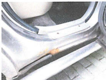
korozja próg przedni prawy
