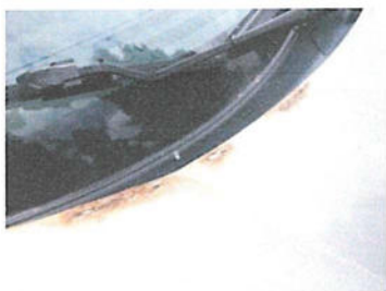
korozja pokrywa przód
