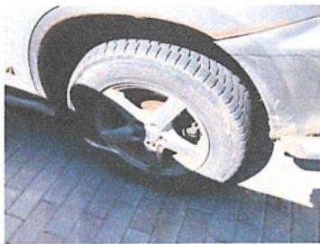
koło pojazdu - korozja elementów układu hamulcowego
