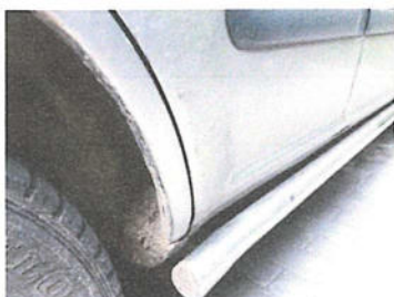
korozja błotnik prawy tył, drzwi prawe tylne
