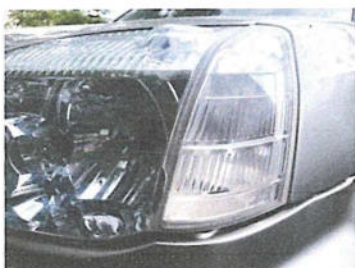
lewy przedni kierunkowskaz ubytek
