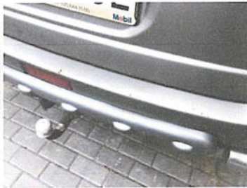
widok pokrywa tył - uszkodzenia nakładki zderzaka
