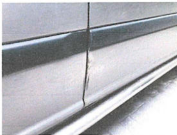
korozja drzwi przednie prawe
