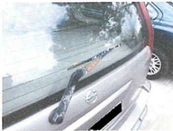
korozja ramie wycieraczki - pokrywa tył
