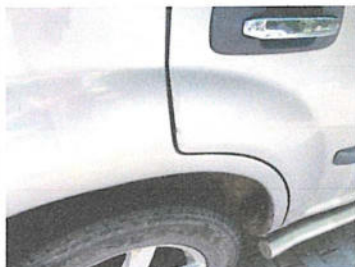
korozja błotnik i drzwi prawy tył
