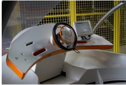
Zdj. 2. Pilot oraz pulpit sterowniczy z elementami interfejsu w mobilnej makiecie eco-samochodu [Dokumentacja projektu Eco-mobilność, Wydział Transportu PW]
