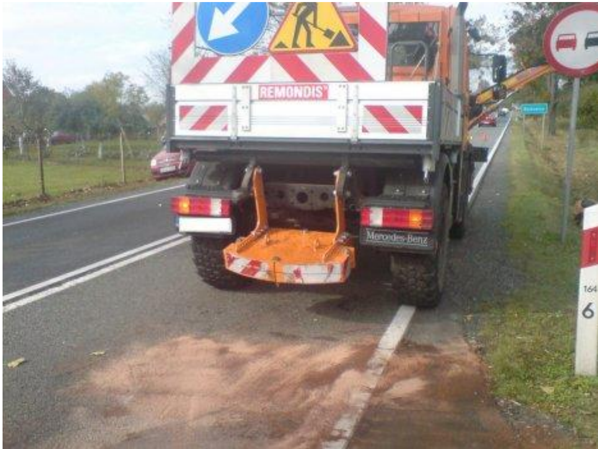
Rys. 13.6. Pojazd stojący na pasie ruchu podczas usuwania skutków wypadku drogowego (oznakowanie na pojeździe wysyłającym żółte światła błyskowe formalnie zmusza kierujących do naruszania przepisów – przejeżdżania przez linię podwójną ciągłą)
