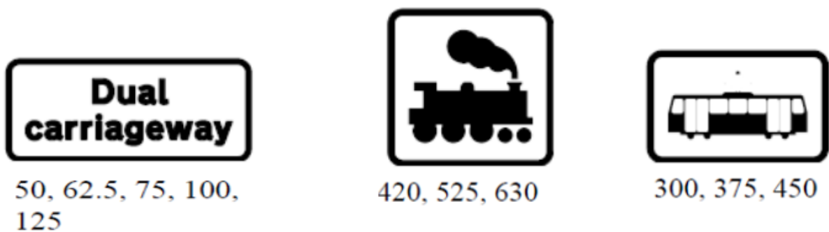
Rys. 7.11. Przykłady tabliczek umieszczanych pod znakami (podany wymiar dotyczy wysokości). W przypadku tabliczki Dual carriageway wymiary dotyczą wysokości małych liter
