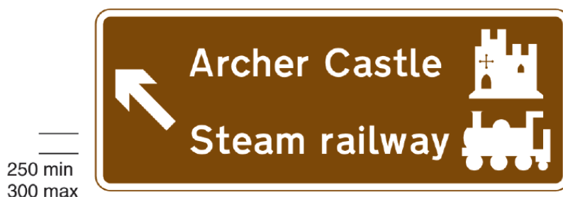
Rys. 7.28. Przykład tablicy autostradowej kierującej do atrakcji turystycznych
