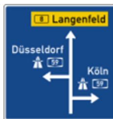
Rys. 7.83. Symbol tablicy przeddrogowskazowej stosowanej na autostradach
