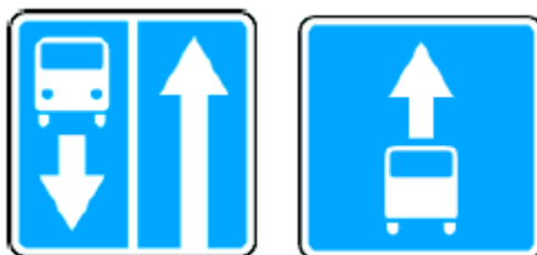
Rys. 8.27. sposób oznakowywania pasów ruchu przeznaczonych dla transportu publicznego za skrzyżowaniem w Rosji
