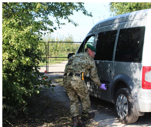
Fot. 16. Radiometrysta podczas wykonywania pomiarów dozymetrycznych pojazdu (źródło własne).
