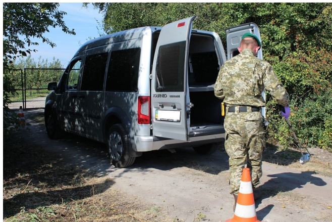
Fot. 18. Radiometrysta podczas poszukiwania skażeń powierzchniowych wewnątrz i na zewnątrz pojazdu oraz przy miejscu, gdzie zarejestrowano najwyższą wartość mocy dawki promieniowania jonizującego (źródło własne).
