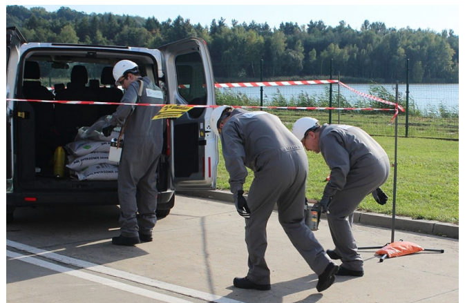
Fot. 10. Przygotowanie do przełożenia źródła promieniowania jonizującego do pojemnika osłonowego (jest on przenoszony w najbliższe otoczenie pojazdu przez członków ekipy dozymetryczna Prezesa PAA) (źródło własne).
