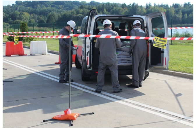
Fot. 9. Ekipa dozymetryczna Prezesa PAA podczas wykonywania pomiarów pojazdu (źródło własne).
