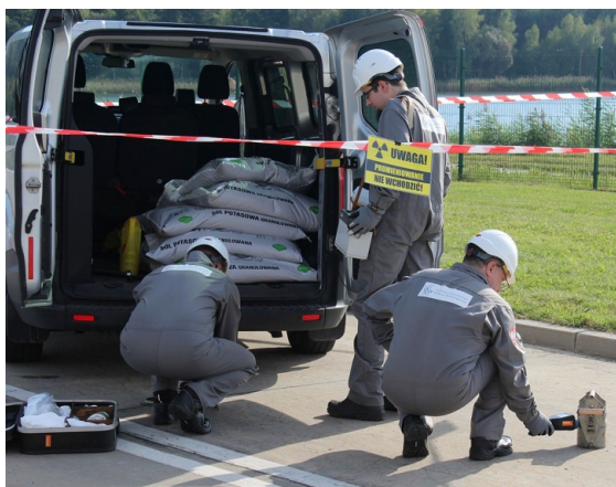
Fot. 11. Po umieszczeniu źródła promieniotwórczego w pojemniku osłonowym przeprowadzono pomiary mocy dawki promieniowania jonizującego na powierzchni pojemnika (źródło własne).
