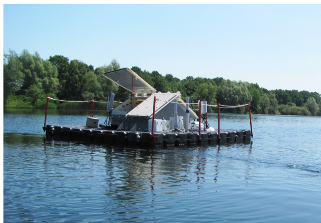
Fot. 1. Pływająca platforma na jeziorze niedaleko miasta Brunzshwik używana przez niemiecki instytut PTB do kalibracji przyrządów dozymetrycznych w zakresie odpowiedzi na promieniowanie kosmiczne.
