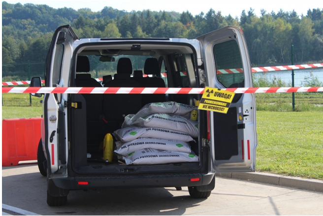
Fot. 7. Wokół pojazdu została wyznaczona strefa zamknięta. Pomiędzy workami z nawozem widać źródło promieniowania jonizującego w metalowej puszcze (źródło własne).
