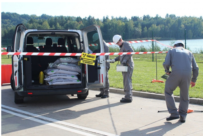
Fot. 8. Ekipa dozymetryczna Prezesa PAA podczas wykonywania pomiarów pojazdu (źródło własne).
