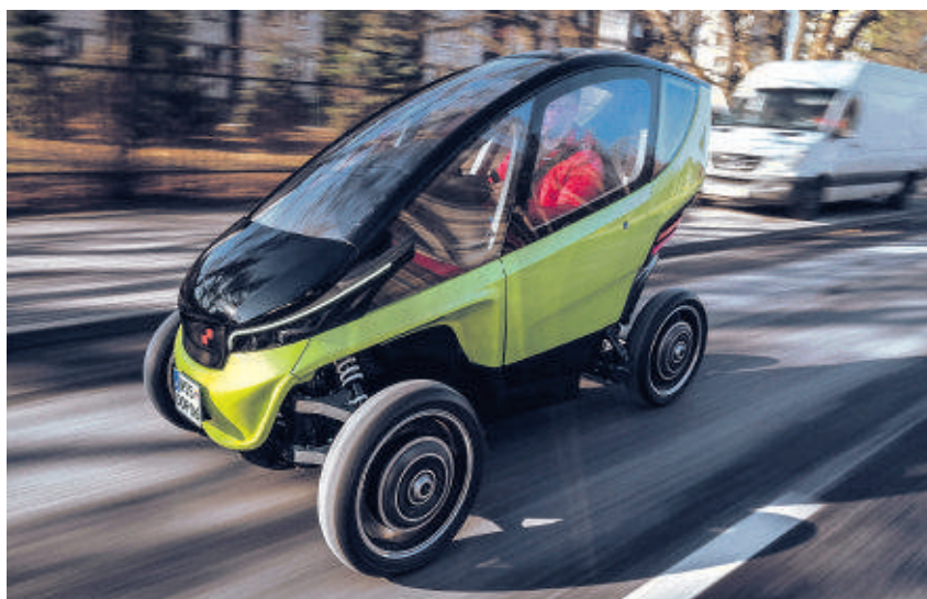
Trigo je revolucionarno električno vozilo, ki združuje prednosti avtomobila in motocikla z reguliranimi razmikom osi. ✂ tiskovno gradivo Trigo.city
