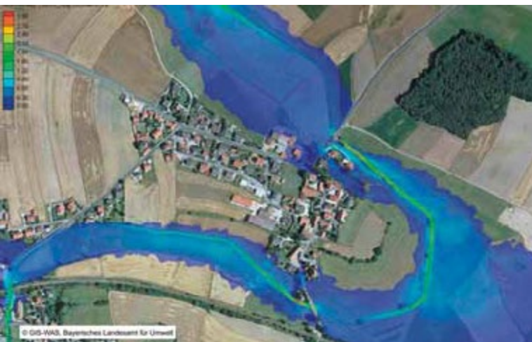
Na podstawie danych uzyskiwanych drogą skanowania laserowego i teledetekcji skonstruowano dokładne modele wód Bawarii.
