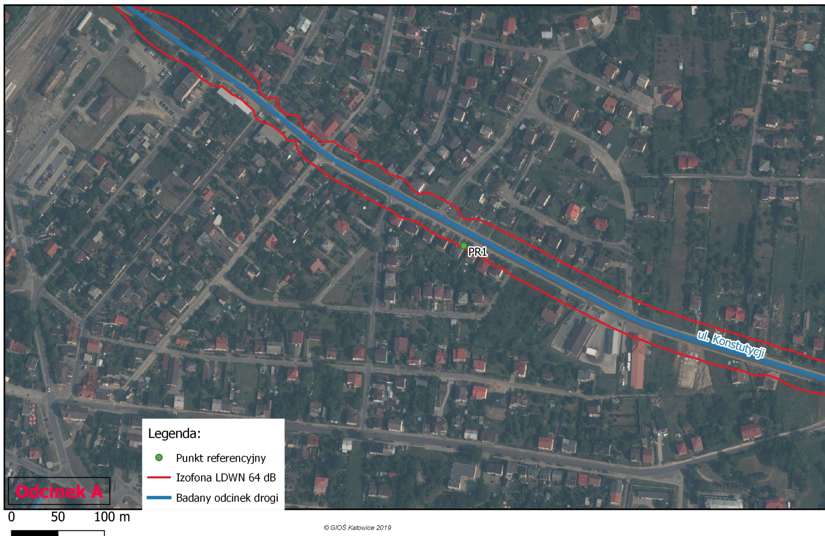
Ryc. 11. Mapa akustyczna odcinka „A” dla wskaźnika oceny hałasu L_{DWN} w rejonie badań RB1 – Łazy, ul. Konstytucji 3-go Maja, 2018 rok.
