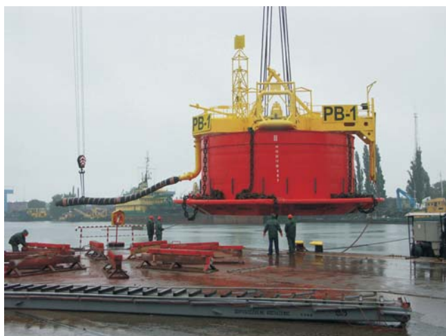
Rys. 10.15. Boja cumowniczo-przelewowa PPIEZRiG Petrobaltic z łańcuchami kotwicznymi, miejscem cumowania tankowca, króćcem i odcinkiem węża pływającego do przesyłu ropy naftowej na tankowiec
