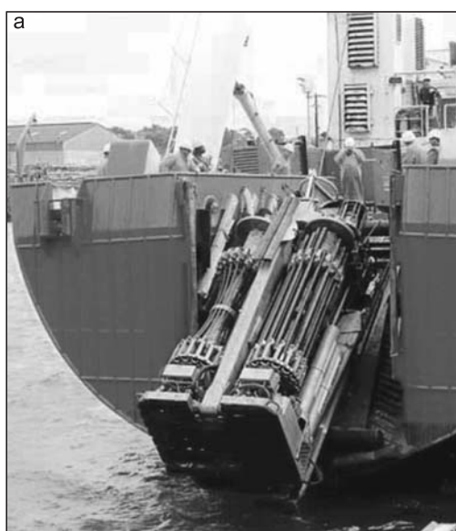
Rys. 7.21. Zdalnie sterowana zaburtowa jednostka wiertnicza PROD TM : a – opuszczana z rufy statku, b – po rozstawieniu łap
