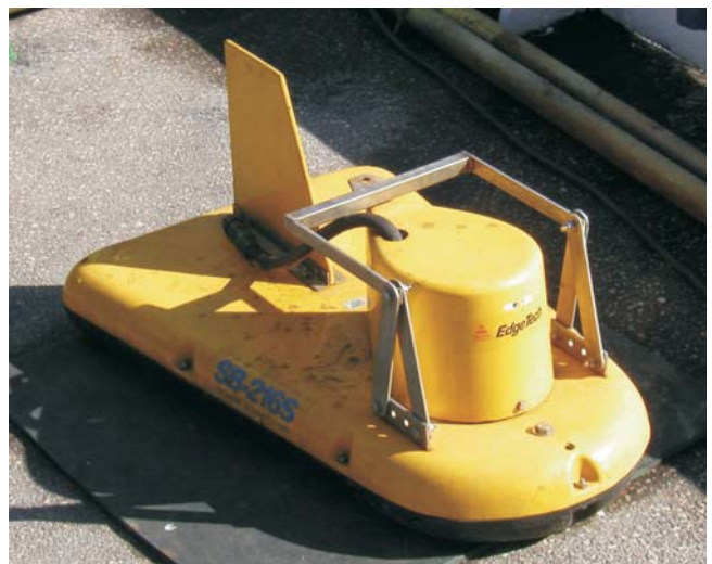
Rys. 7.17. Charakterystyczny kształt przetwornika aparatury typu chip; aparatura X-STAR SB-216S
