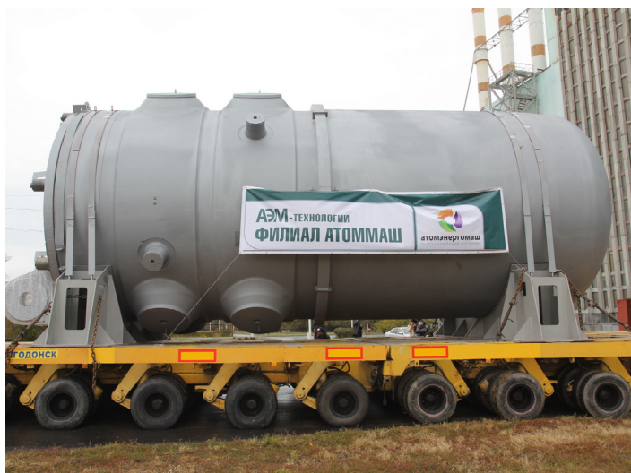
Fot. 1. Wyprodukowanie zbiornika reaktora WWER-1200 dla białoruskiej EJ Ostrowiec zajęło firmie Atomash jedynie 840 dni. [4] Źródło: Atomash
