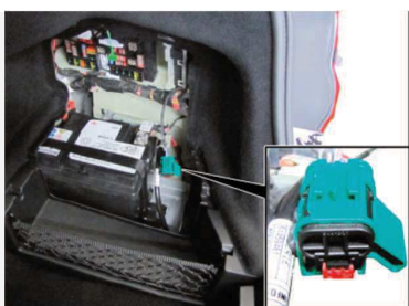
Wysokonapięciowy ratunkowy punkt odłączenia zamknięty.
