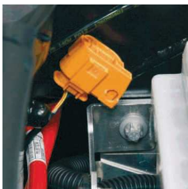
Wysokonapięciowy ratunkowy punkt odłączenia zamknięty.
