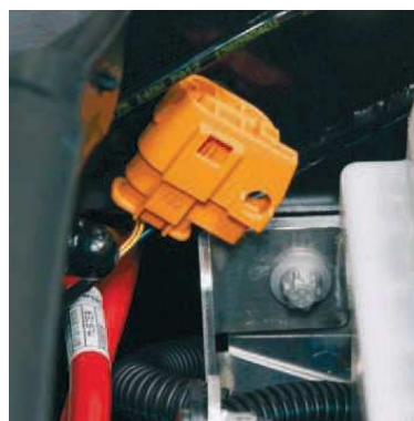
Wysokonapięciowy ratunkowy punkt odłączenia otwarty.
