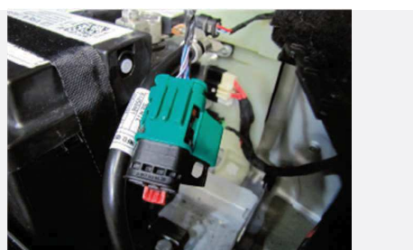
Wysokonapięciowy ratunkowy punkt odłączenia otwarty.
