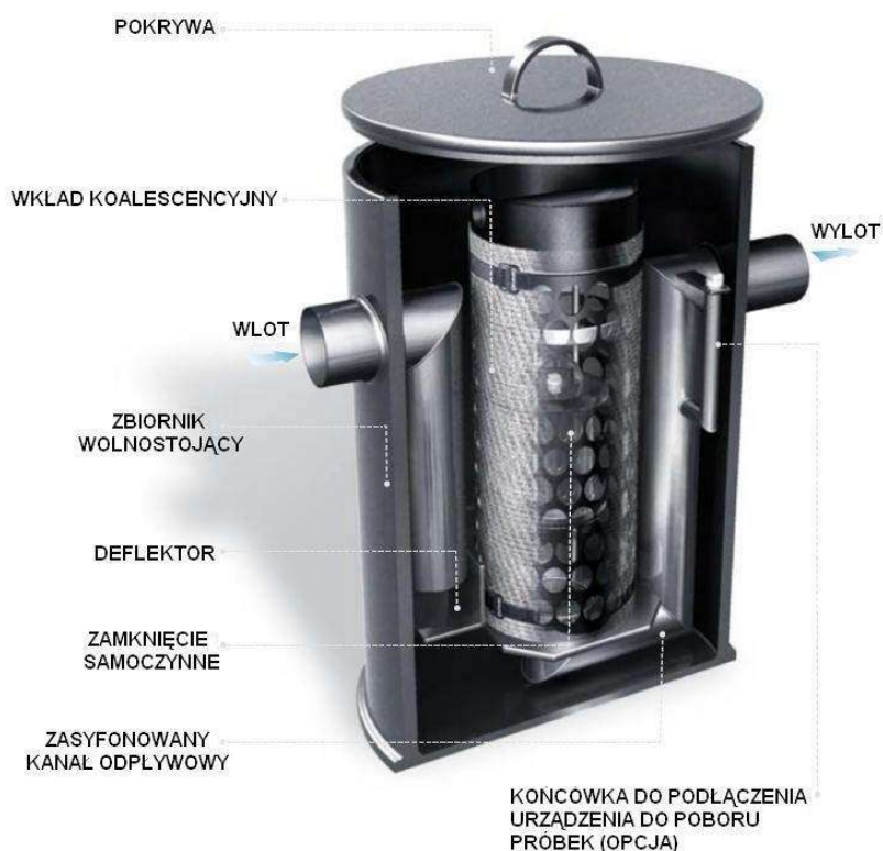
Rys. 8.5.2.2. Przykład rozwiązania separatora koalescencyjnego [21]
