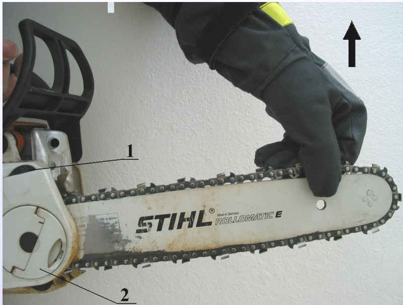
Prawidłowe napięcie łańcucha.
