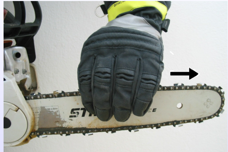
Sprawdzanie płynności ruchu łańcucha tnącego.
