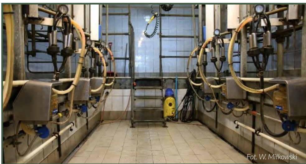
Hala udojowa typu „rybia ość” utrzymana w należytej czystości z podłogą wykonaną z materiałów antypoślizgowych.
