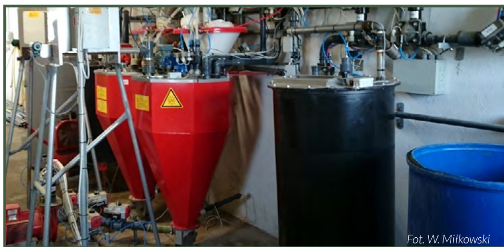
Automatyczny mieszalnik i dozownik pasz na fermie trzody chlewnej
