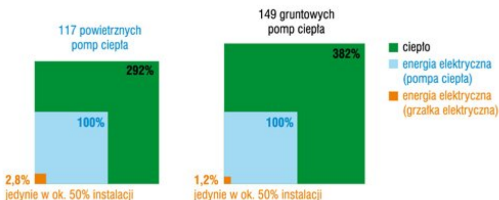
Rys. K4.3. Wyniki pracy 266 pomp ciepła w rzeczywistych warunkach działania (źródło: https://portpc.pl/pompy-ciepla-w-istniejacych-budynkach )
