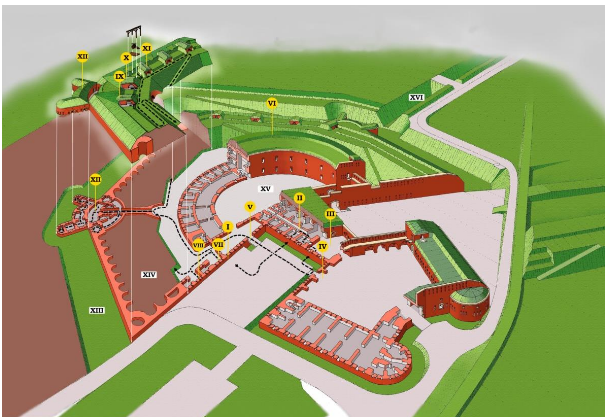
Ryc. 8. Bastion III rdzenia Twierdzy Kraków - funkcjonalnie bastion, strukturalnie - fort poligonalny. Najpóźniejsze realizacje bastionowe z 2 poły XIX wiełu. Widok perspektywiczny Bastionu III „Kleparz” w stanie z ok. 1887 r. wraz ukazaniem jego struktury wewnętrznej i uwagami o realizowanym procesie rewaloryzacji i adaptacji:
