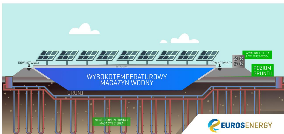
Rysunek 5. Warstwowe ułożenie komponentów Demonstratora Technologii
