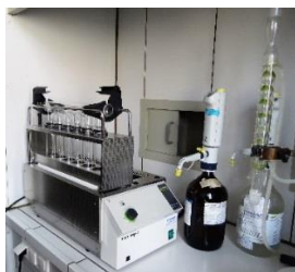
Stanowisko do oznaczania białka w żywności
