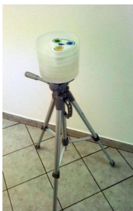
Fantom do testów aparatów rtg pantomograficznych wiązki stożkowej PRO-DENT CT
