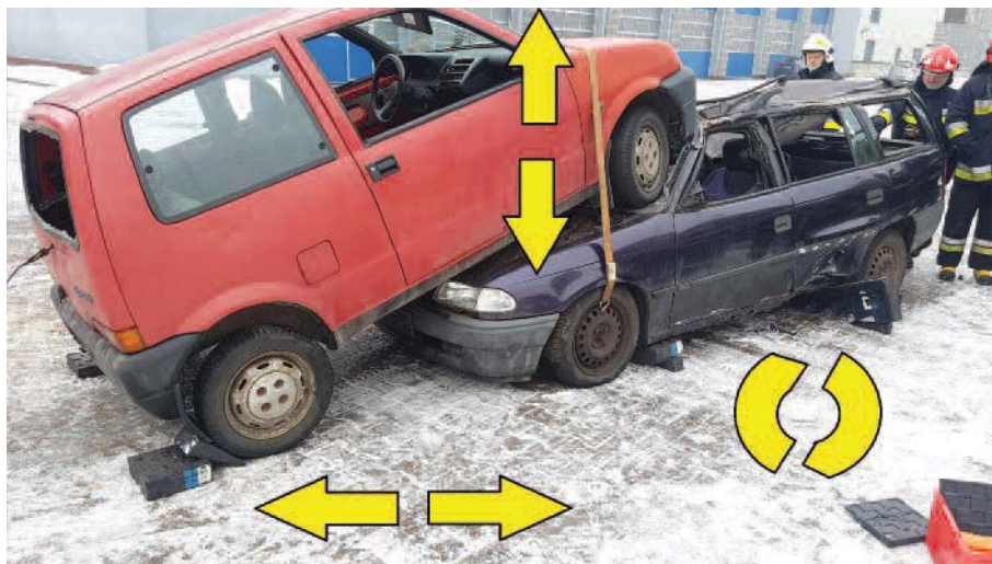
4. Zabezpieczenie układu pojazdów
