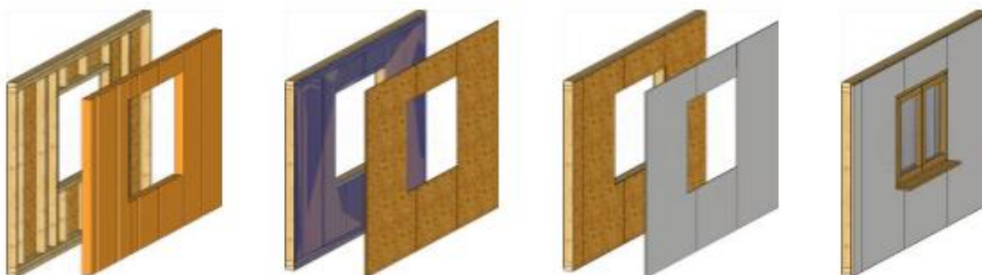
Prefabrykacja pełna – rdzeń izolacyjny uzupełniany w zakładzie prefabrykacji.
