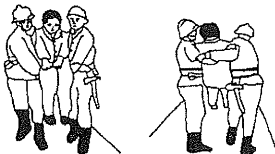
Rys. 4 Przenoszenie „chwytem huśtawkowym” - ratownicy chwytają się za ręce „zewnętrznie”, wkładając je pod siedzenie ratowanego, rękami „wewnętrznymi” po wzajemnym uchwycie na wysokości łokcia zabezpieczają ratowanego od tyłu, tworząc wsparcie na wysokości górnej części jego pleców.
