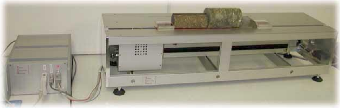
Figura 9.11 TCS Thermal Conductivity Scanning firmy Lippmann and Rauhen GbR (Niemcy) – skaner przewodności i dyfuzyjności termicznej (zdjęcie ze strony producenta: www.geophysik-dr-rauen.de/tcscan/ )
