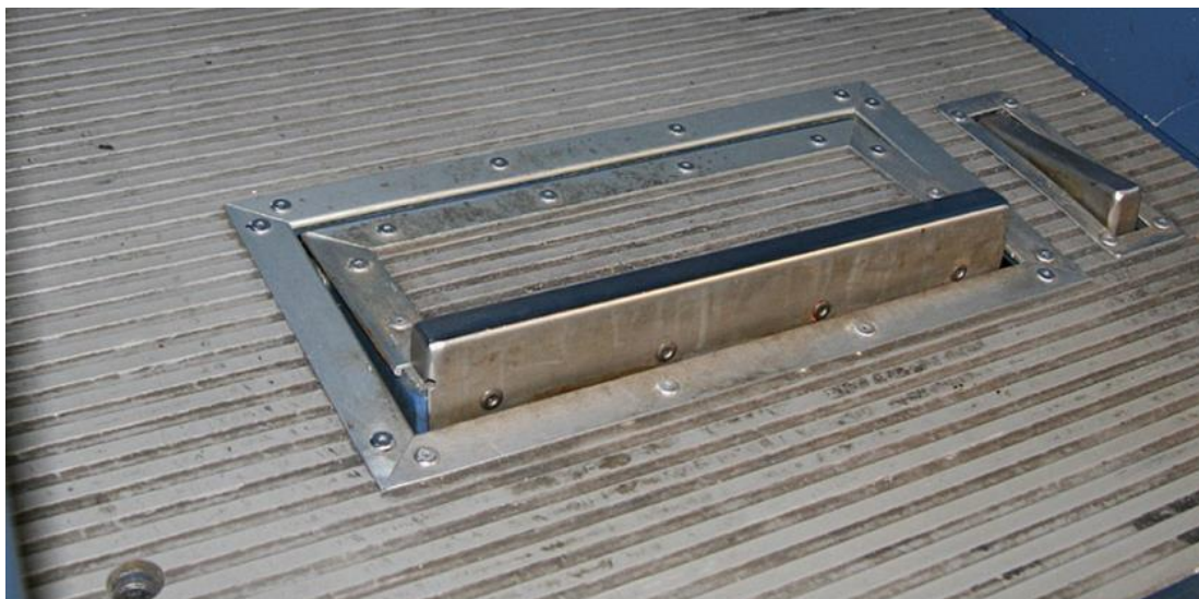
RYSUNEK 4 PEDAŁ - PRZYCISK NOŻNY SYSTEMU SIFA [35].
