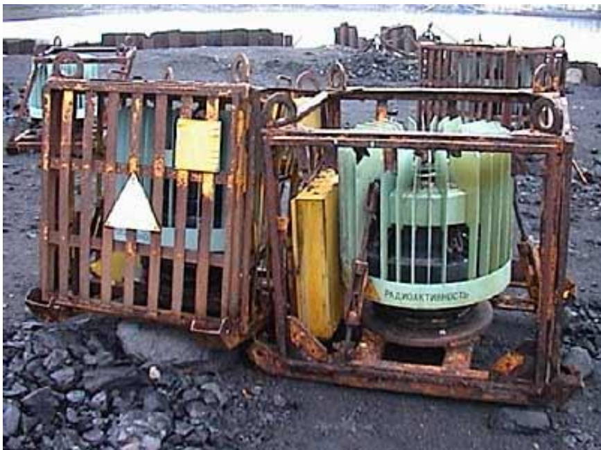
Fot. 5. Niszczące generatory RTG zdemontowane z radzieckich/rosyjskich latani morskich w oczekiwaniu na transport do zakładu utylizacji
