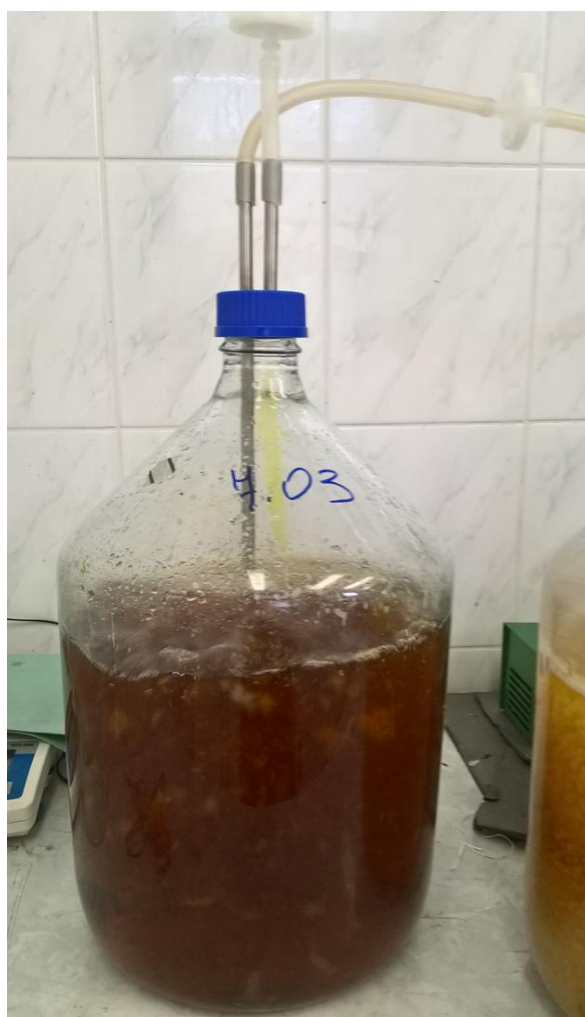
Fot. 19. Biorektor air–lift skonstruowany w Katedrze Botaniki Farmaceutycznej UJ CM (fotografia Bożena Muszyńska)
