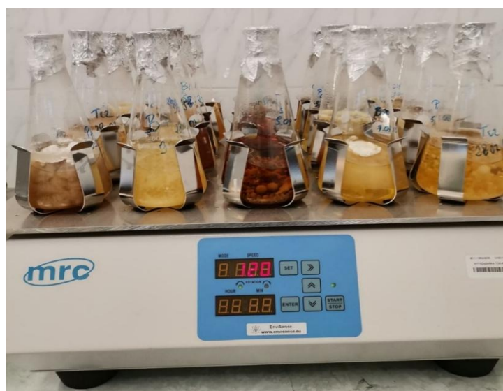
Fot. 14. Kultury płynne umieszczone na wytrząsarce orbitalnej/obrotowej (fotografia Katarzyna Kała)
