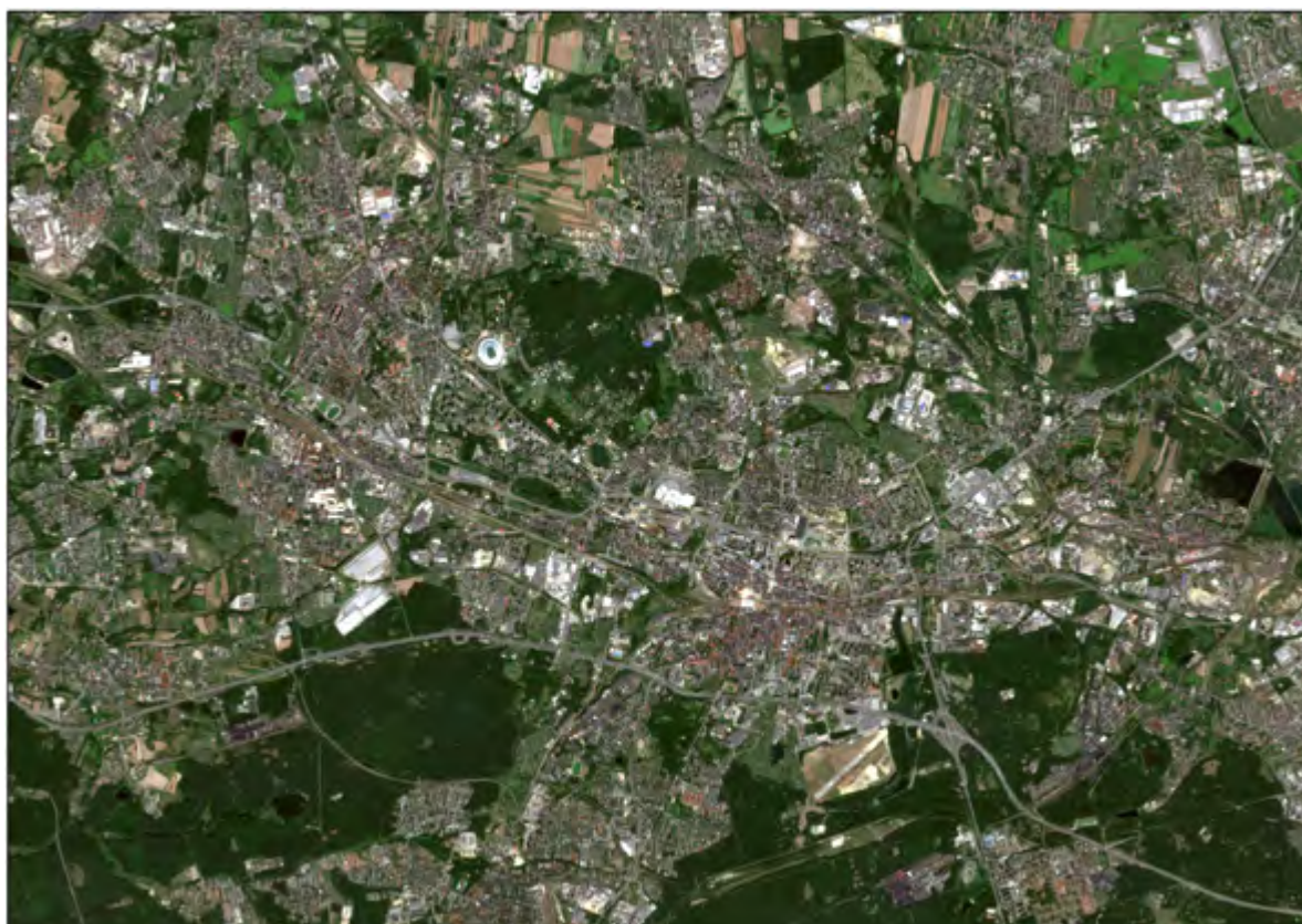
Rys. 6.4: Przykład zdjęcia optycznego dla miasta Chorzów zarejestrowanego przez satelitę Sentinel-2. Rozdzielczość terenowa piksela wynosi 10 m. Data rejestracji obrazu 16.08.2017 r. Źródło: Portal scihub.copernicus.eu.
