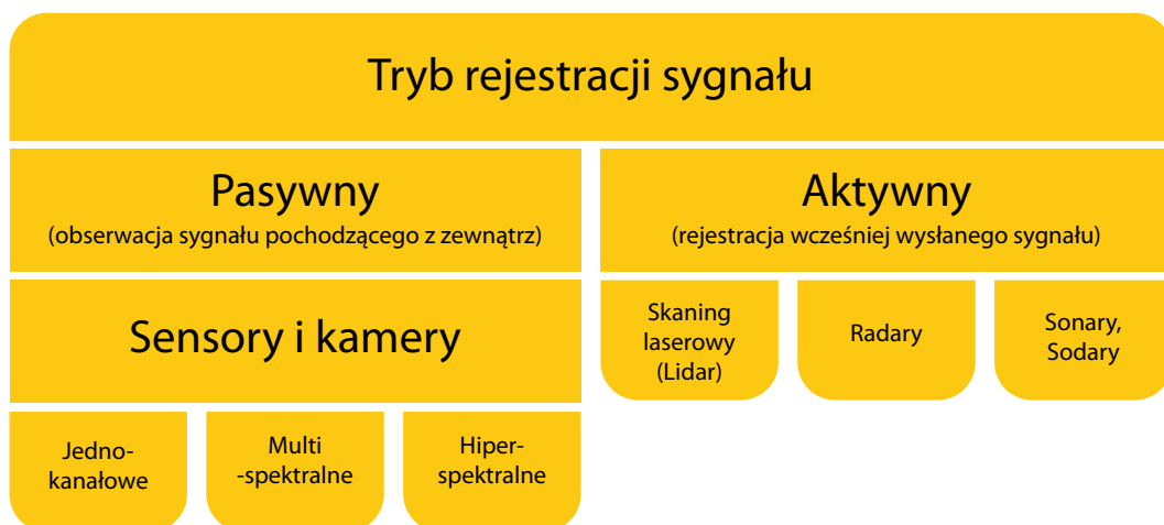
Rys. 4.3: Podział pomiarów teledetekcyjnych ze względu na tryb rejestracji sygnału.
