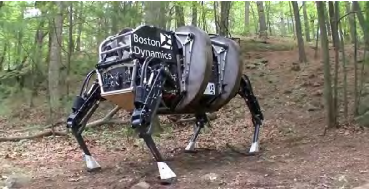
Rys. 2.1 Robot Boston Dynamics dzięki teledetekcji i technikom GNSS zachowuje orientację w przestrzeni i porusza się wśród przeszkód (źródło Boston Dynamics).
