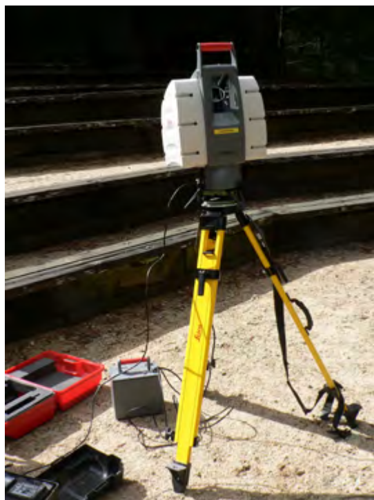
Rys. 5.1: Naziemny skaner laserowy firmy Leica. W trakcie pomiaru skaner obraca się w dwóch płaszczyznach wysyłając wiązkę lasera, która mierzy kąt oraz odległość skanera do mierzonego obiektu. W wyniku powstaje chmura punktów. (źródło Wikipedia).
