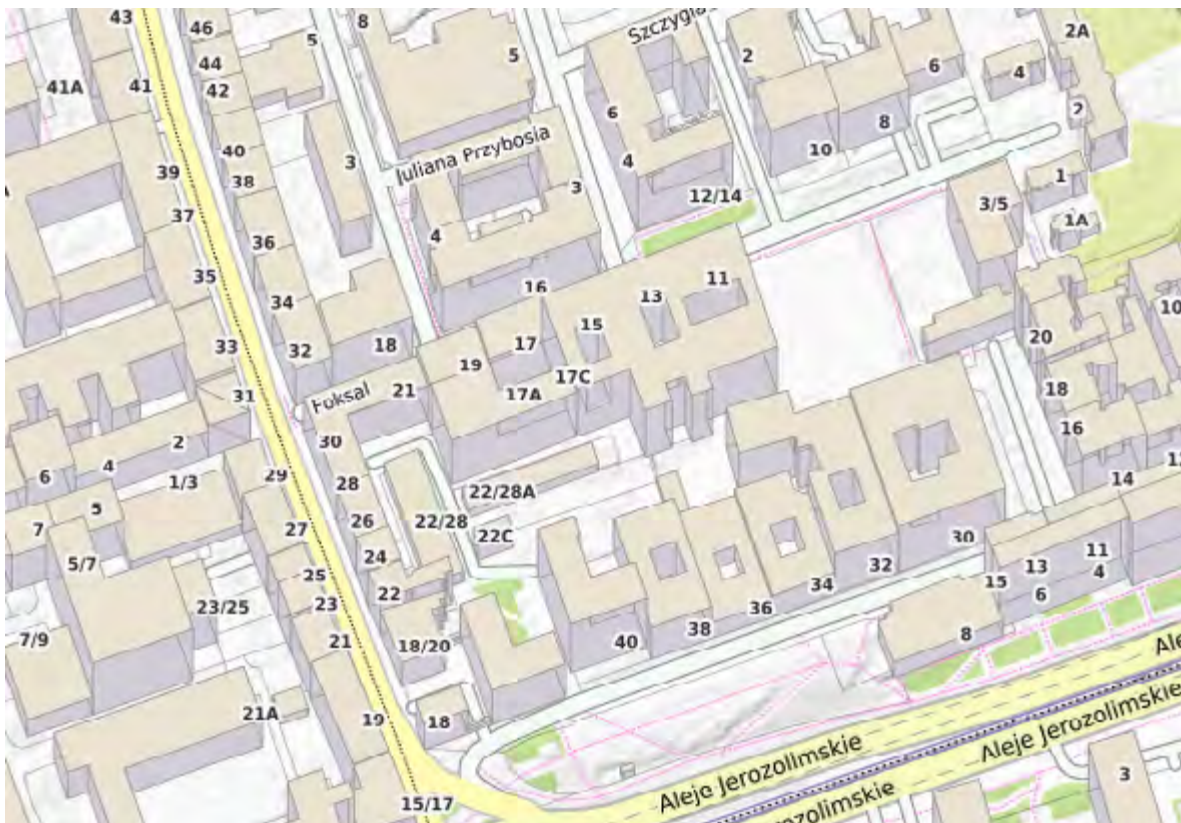
Rys. 3.7: Obliczona i zwizualizowana wysokość zabudowy na podstawie modeli terenu. Liczbowo przedstawiono dodatkowo numer porządkowy nieruchomości (Źródło OnGeo.pl).
