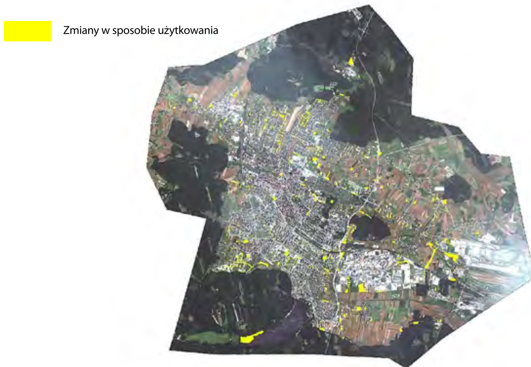
Rys. 3.4: Wizualizacja różnic w użytkowaniu terenu zawartych pomiędzy rejestrem EGiB a stanem faktycznym w mieście Tychy w roku 2012 wykrytym na podstawie aktualnej ortofotomapy. (Źródło: archiwum SmallGIS).
