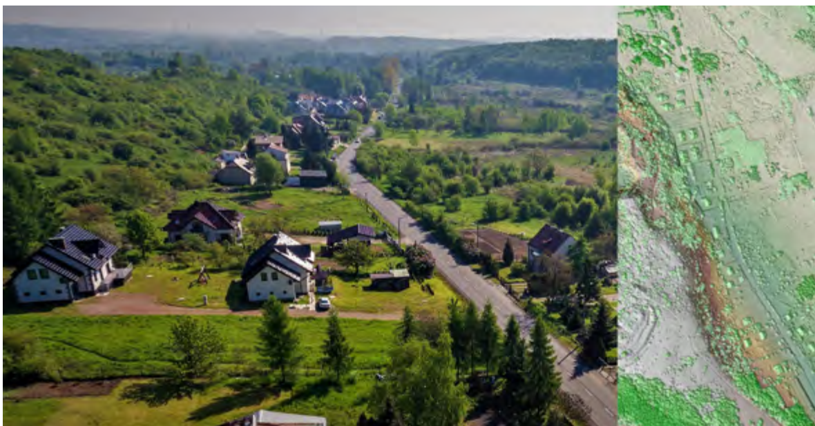
Rys. 10.1. Przykładowe dane teledetekcyjne: zdjęcie z drona i cyfrowy model pokrycia terenu ze skanowania LIDAR, wykorzystywane w analizie wrażliwości krajobrazu. Ulica Tyniecka w Krakowie (źródło SmallGIS).
