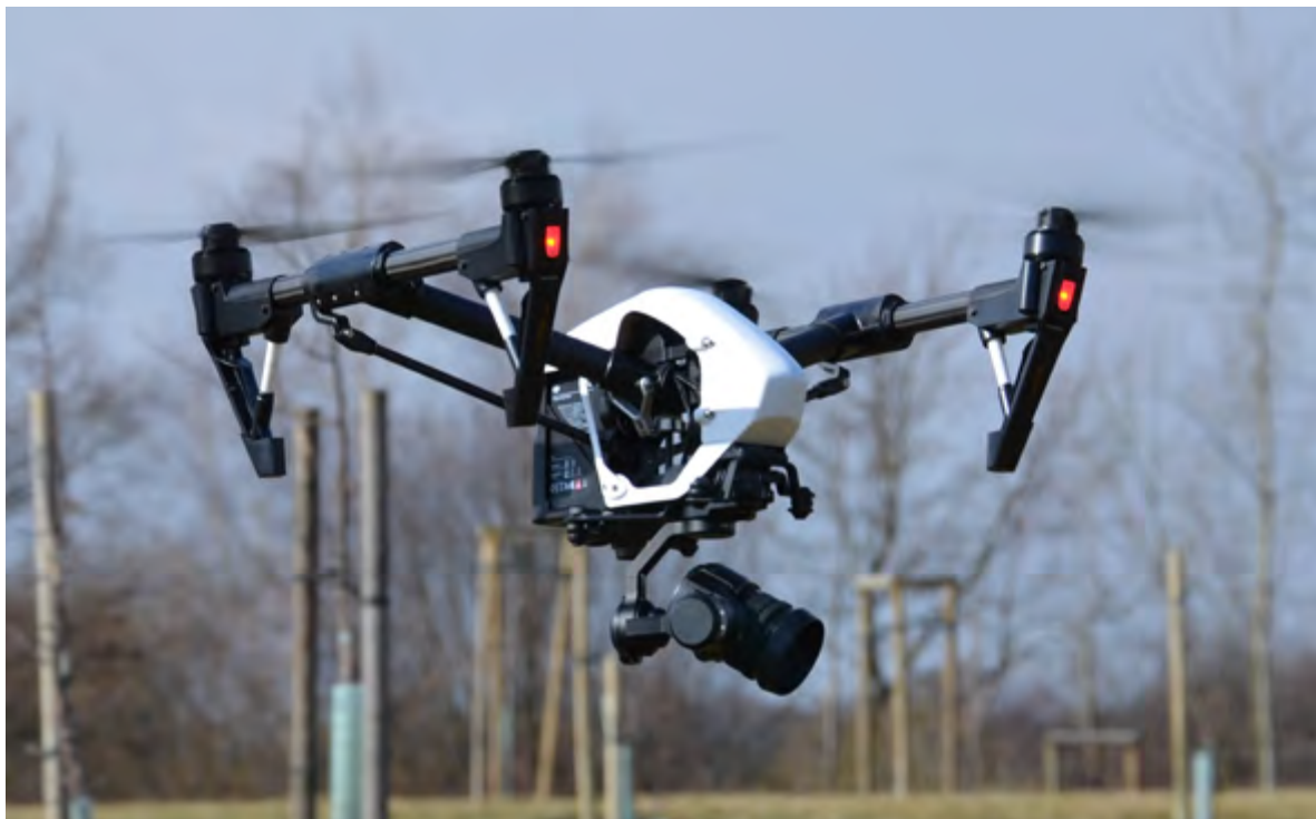
Rys 5.2: Jeden z podstawowych modeli dronów firmy DJI umożliwiający wykonanie ortofotomapy w pasmach RGB (źródło Navigate sp. z o.o.).
