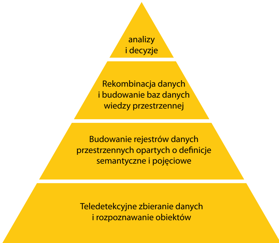
Rysunek. 3.9: Typowy schemat przepływu informacji poprzez różne poziomy organizacji danych przestrzennych – od pomiaru do podejmowania decyzji.
