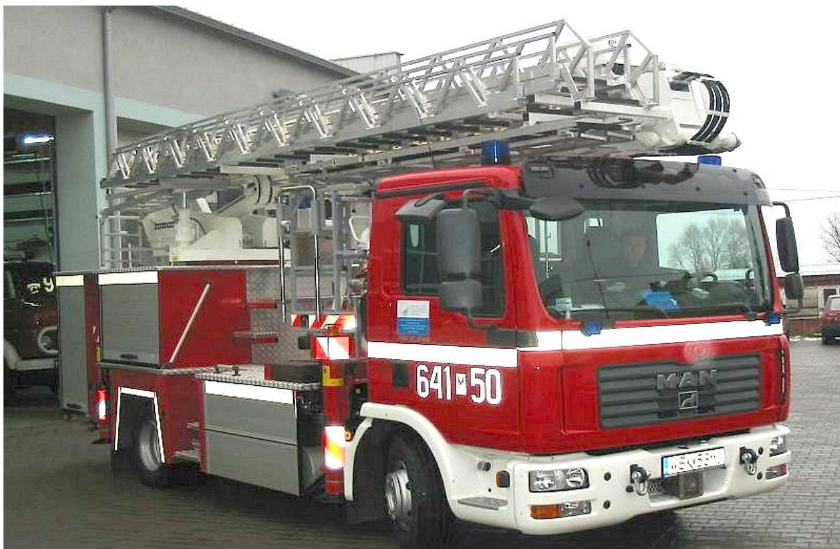
Samochód specjalny podnośnik PMT – 25D (SHD – 25) na podwoziu MAN TGL 12.240 4X2 rok produkcji 2008.
