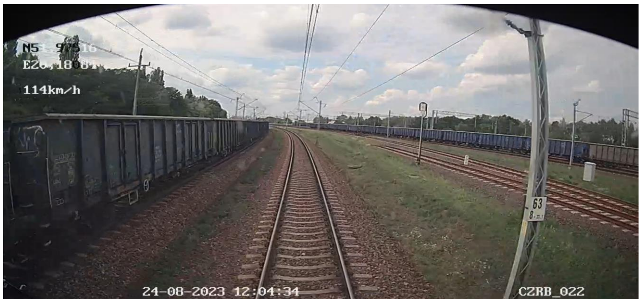
Zdjęcie 12 - Widok semafora J1 1/2/3/m z odległości 340 m w dniu zdarzenia z jadącym równoległe pociągiem.
