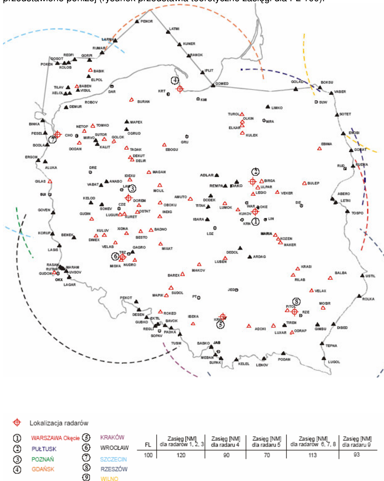
Rys. 8.15. Teoretyczne zasięgi źródeł radiolokacyjnych pracujących na rzecz systemu AMS 2000Plus.
