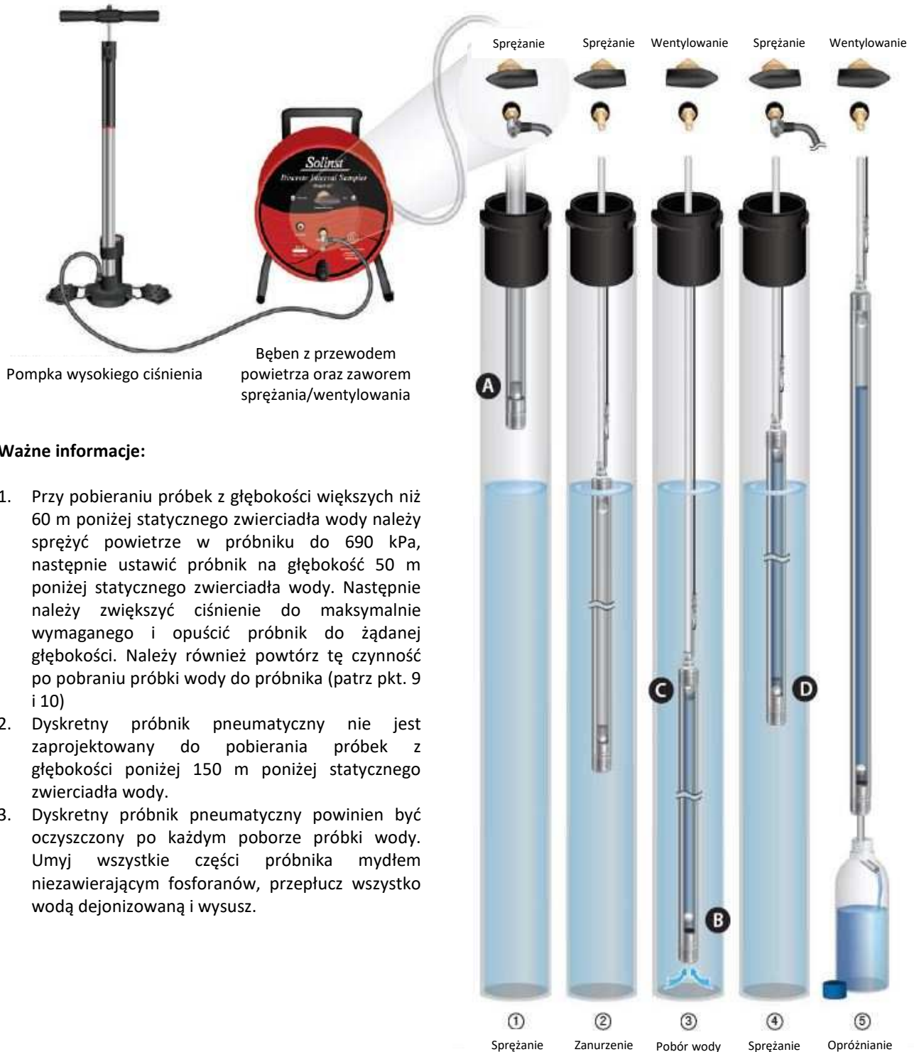
Rys. 1. Schemat działania dyskretnego próbника pneumatycznego
