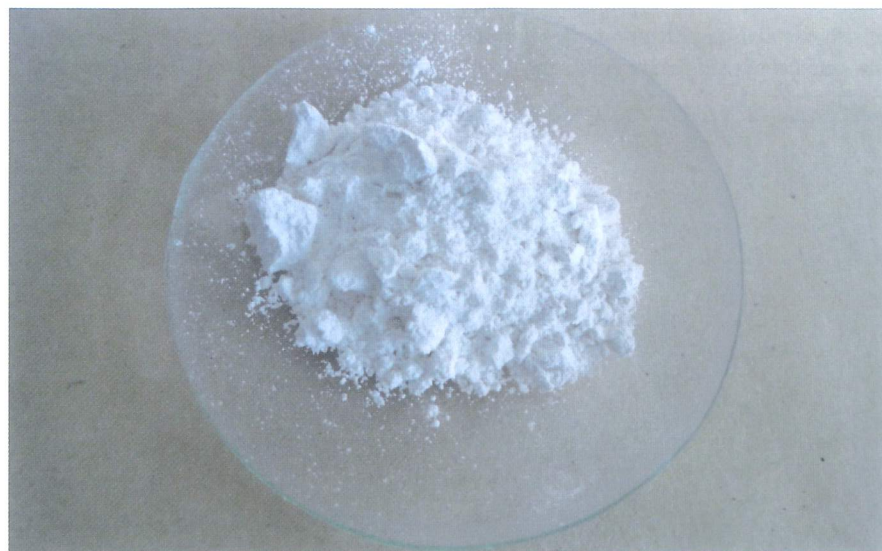
Nadtlenek baru jest także utleniaczem, stosowanym np. do bielenia i w pirotechnice
