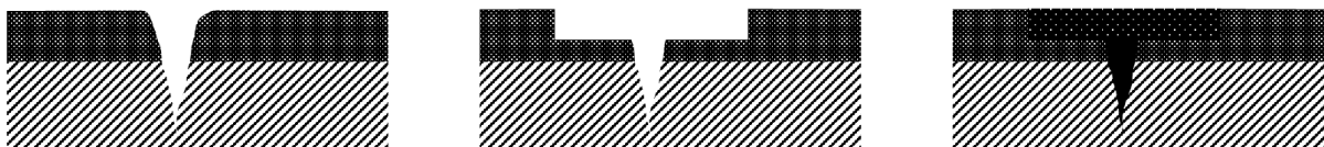
Rys. 4.8.1.1. Schemat wypełniania pęknięć metodą pasmową
