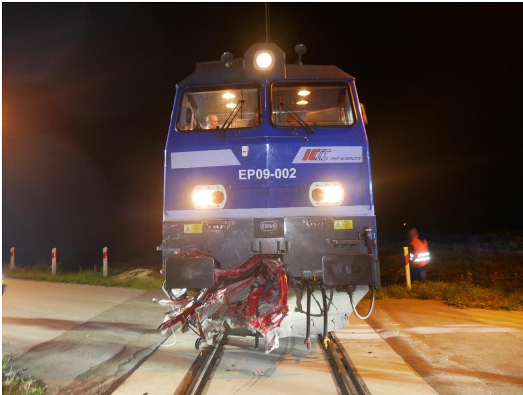
Zdjęcie 9 - Uszkodzona kabina "B" EP09-002 po zdarzeniu [źródło: fot. własne Zespołu badawczego]
