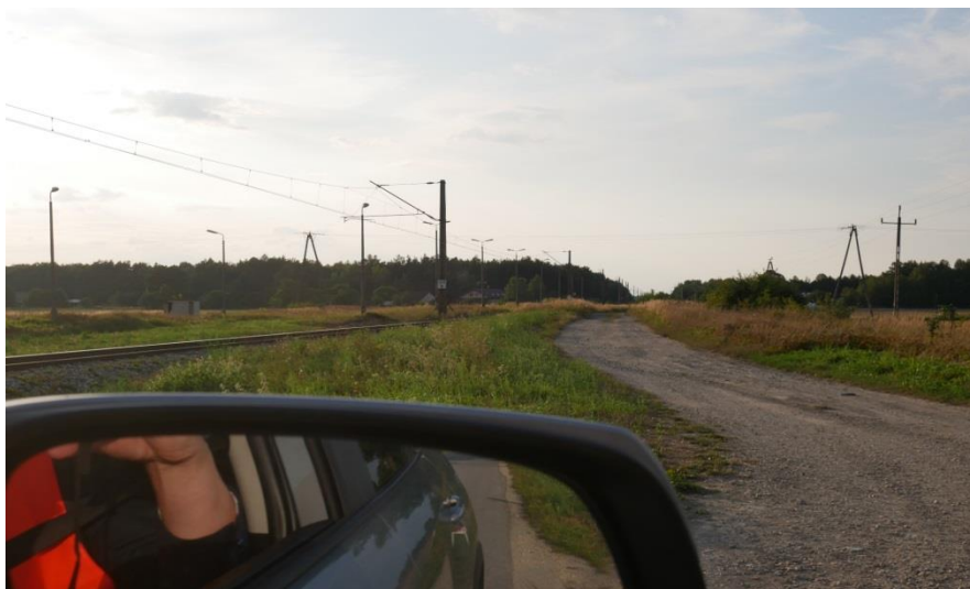
Zdjęcie 3 - Widoczność z 10 m (w kierunku nadjeżdżającego pociągu) [źródło: fot. własne Zespołu badawczego]
