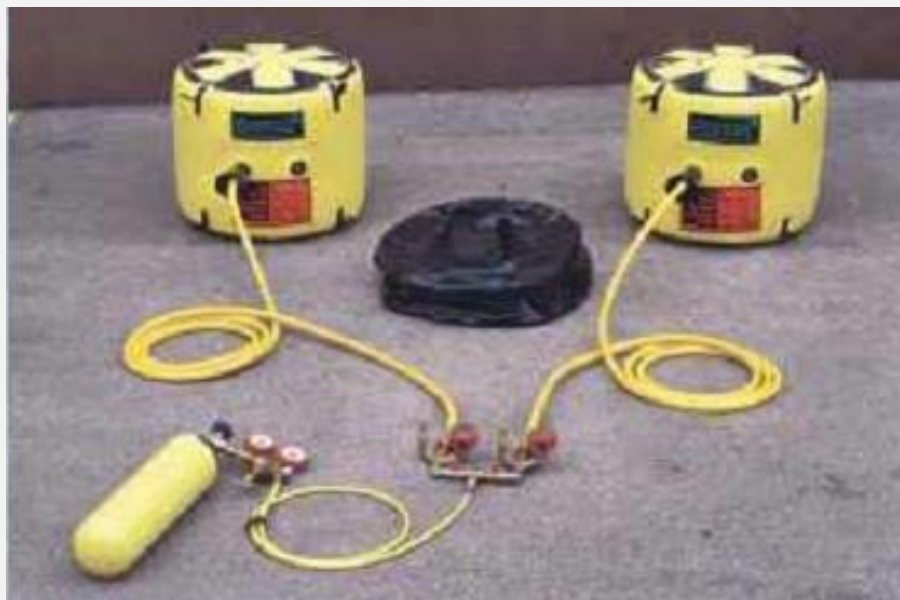
Rysunek nr 16. Złożony zestaw ratowniczy pneumatyczny niskociśnieniowy [1,2,3].
