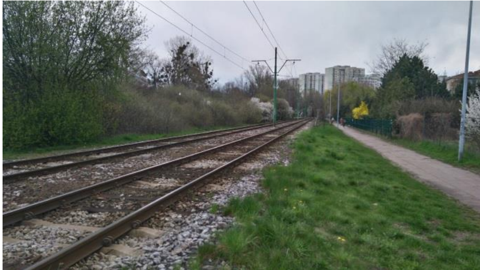
Rys. 5-17 Torowisko tramwajowe standardowe – rozstaw szyn 1435 mm
