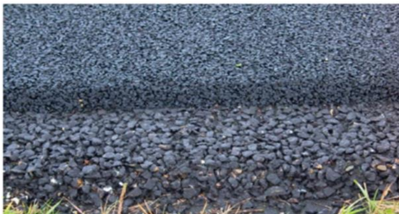
Rys. 4-21 Przykład nawierzchni PA – dwie warstwy 29
