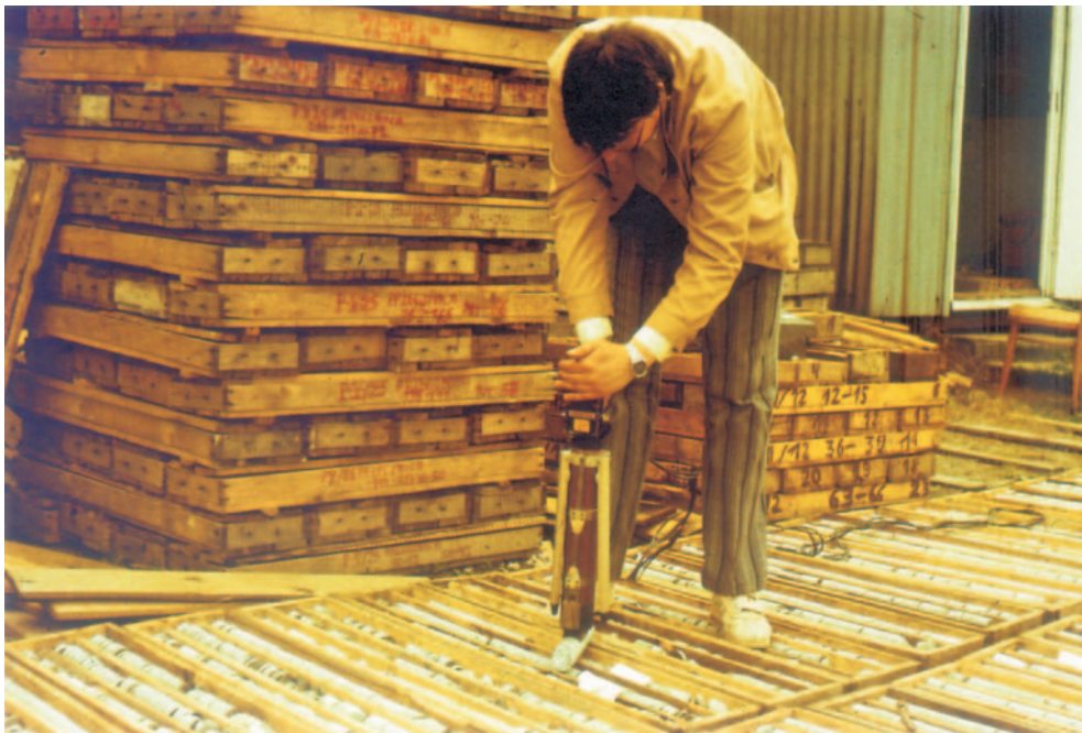
Rys. 6.4. Opróbowanie rdzeni wiertniczych ze złoża cyny w Gierczynie przy pomocy przenośnej aparatury rentgenofluorescencyjnej (fot. M. Nieć)
