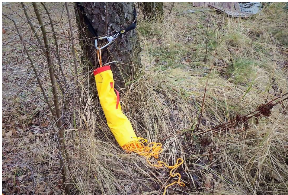
Zdj. 59 Przykładowy sposób zabezpieczenia końca liny asekuracyjnej
