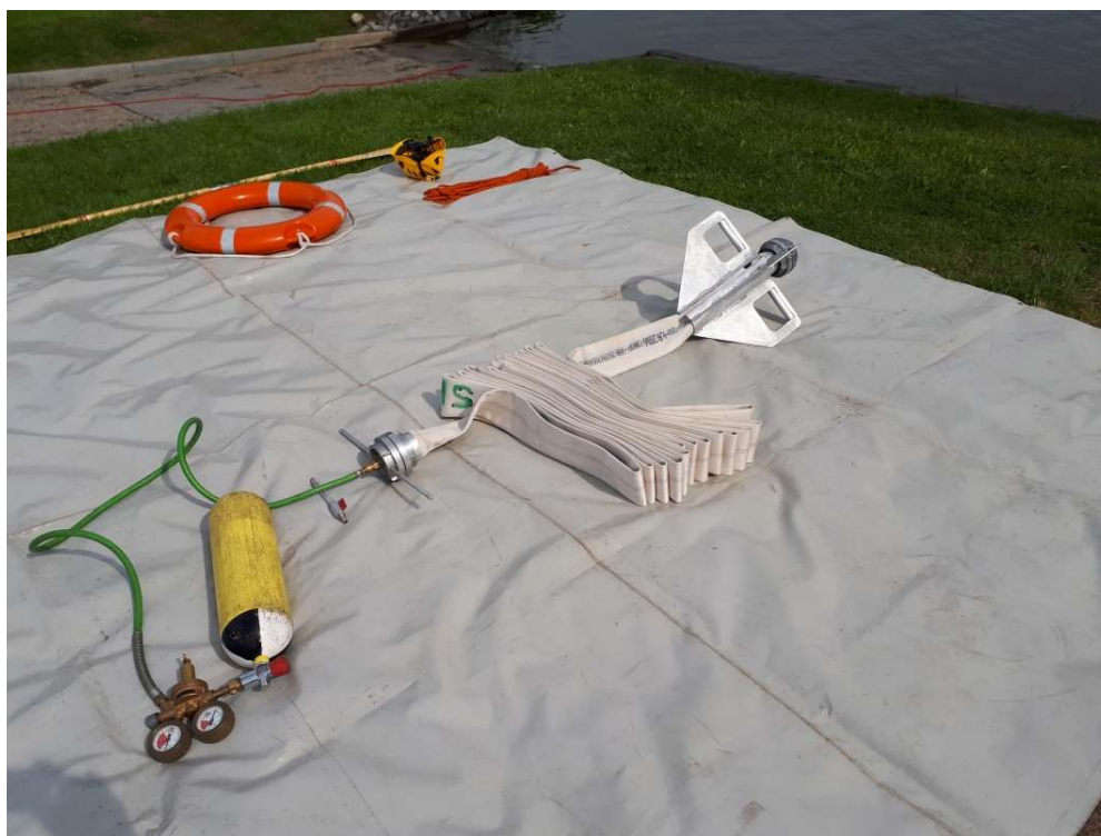
Zdj. 30 Połączenie butli z reduktorem ciśnienia i pokrywą z króćcem pneumatycznym Autor: asp. K. Bartoszak
