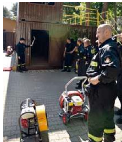
Przyjęta metoda badania polegała na pomiarze prędkości powietrza w otworze wylotowym przy zmieniającej się odległości danego wentylatora od otworu wlotowego
