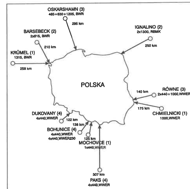
Rys. 1.12. Elektrownie jądrowe w odległości do ok. 300 km od granic Polski (w nawiasach podano liczbę czynnych reaktorów energetycznych)
